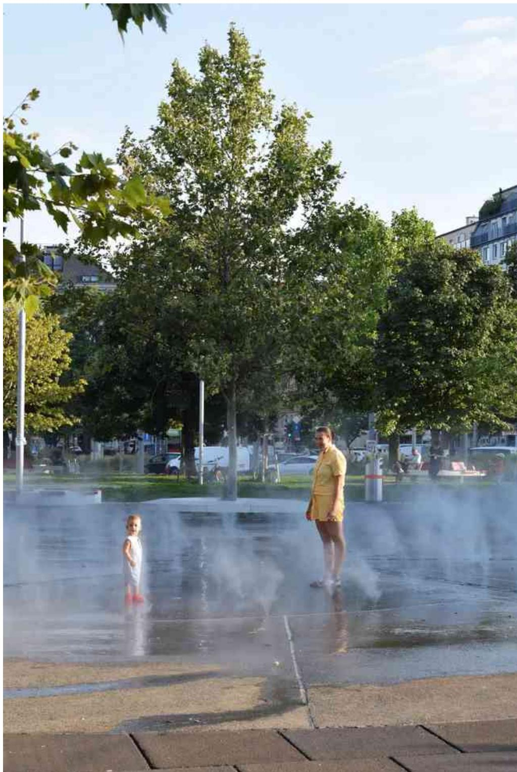
© Kris Hendrickx/BRUZZ | Vous pouvez trouver des systèmes de brouillarde sous différentes formes dans plus de trois cents endroits à Vienne : des installations de pulvérisation qui sont automatiquement activées lorsque la température reste supérieure à 27°C pendant plusieurs jours.
